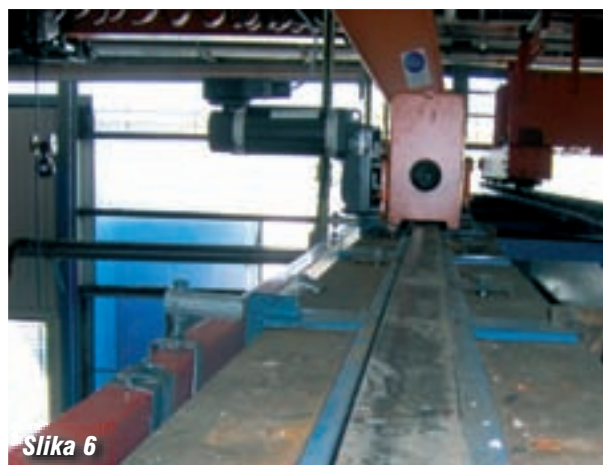
Godine 2007. montirana je i 12 tonska dizalica jednogredne izvedbe
